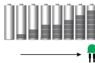
„Jeśli oprawa w trakcie rozładowania akumulatora (w trakcie świecenia) zacznie pulsować białymi diodami to należy rozpocząć proces ładowania akumulatora (przywrócić zasilanie do oprawy). W przeciwnym wypadku akumulator ulegnie dalszemu rozładowaniu i diody zgasną całkowicie.”
